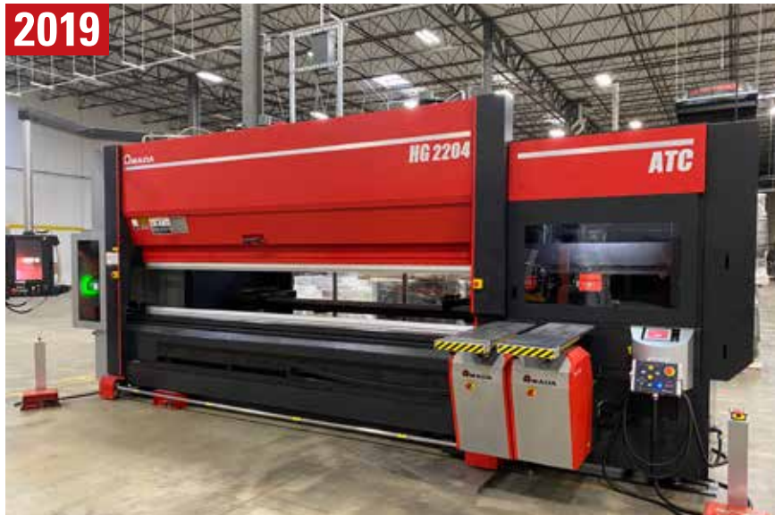
AMADA HG2204ATC 8-AXIS 240 TON PRESS BRAKE
