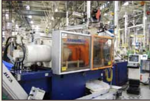
(5) 165 Ton Krauss-Maffei 150-620-B2 Injection Molding Presses
