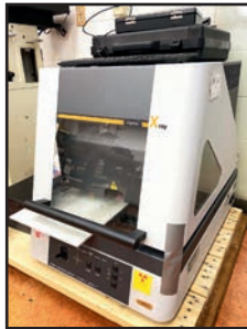
FISCHER TECH FISCHERSCOPE X-RAY XDL SPECTROMETER
