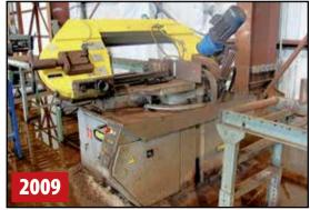
FMB PEGASUS SEMI-AUTOMATIC HORIZONTAL BANDSAW
