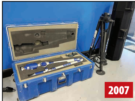
FARO PLATINUM ARM PORTABLE CMM
