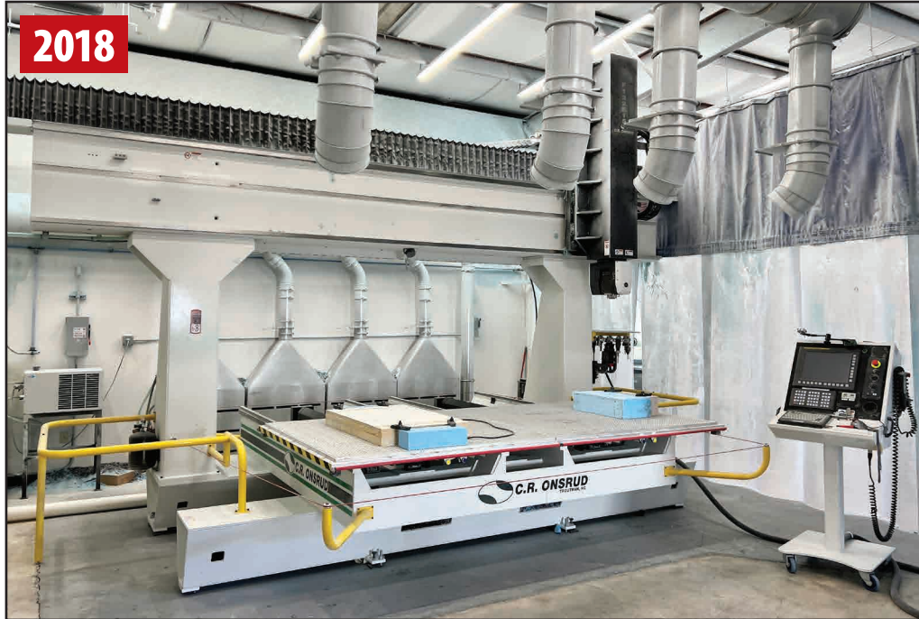
ONSRUD F122E15 5-AXIS CNC ROUTER
