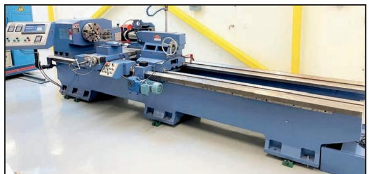
POWER PSM 4030/03 RUBBER ROLLER GRINDING MACHINE
