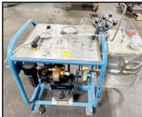
H. LORIMER CORP. HYDROSTATIC TEST STATION
