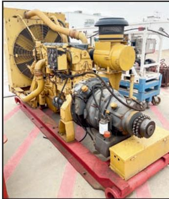
CAT C15 DIESEL ENGINE POWER UNIT
