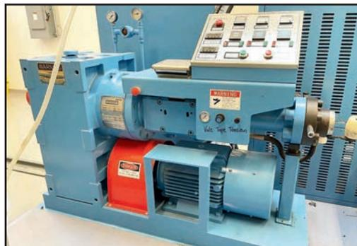
POWER PTM-3040/03 RUBBER EXTRUDER/ROLL TWISTING LATHE SYSTEM
