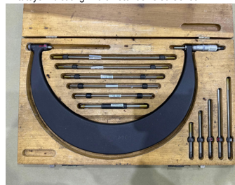
Scherr-Tumico OD Micrometer with anvils
