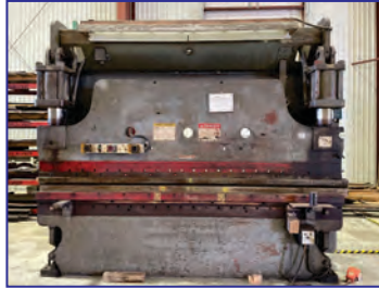
175 Ton Cincinnati 175 CB Press Brake
