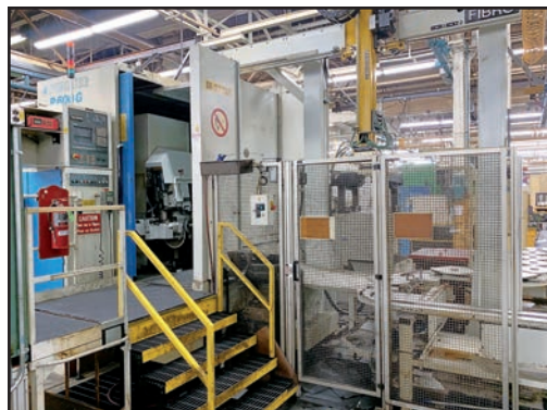
PFAUTER P600G CNC GEAR GRINDER
