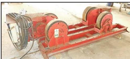
15-TON/25-TON A&N PLANT VCR-300DM TURNING ROLL SET
