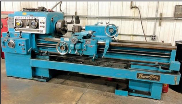
LODGE & SHIPLEY POWER TURN 20" X 60" ENGINE LATHE
